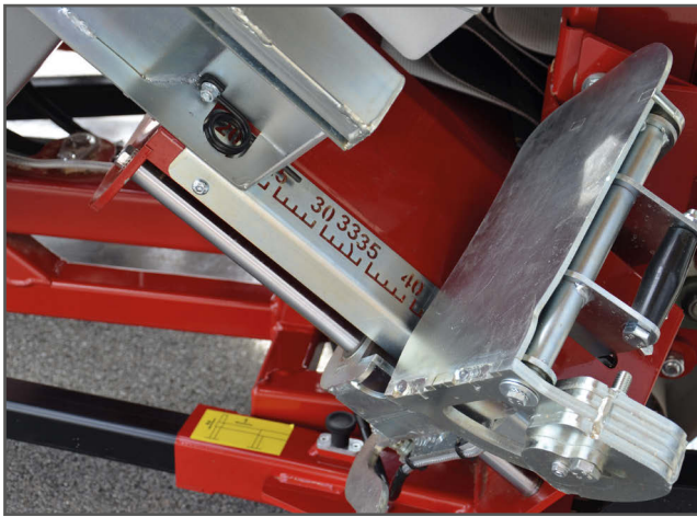
Verstellbarer Längenanschlag mit Feinstufen von 200 - 520 mm
