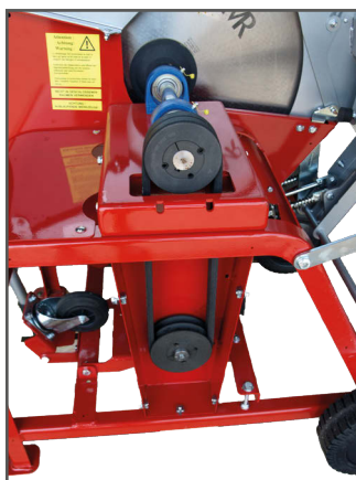
Keilriemenantrieb bei WSA-700 PE
