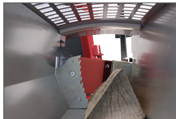
Der Niederhalter verhindert das Verdrehen des Holzes
