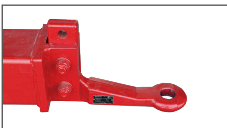
Höhenverstellbare Zugöse und stabile Deichsel
