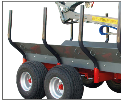
Einlegewanne halbe Höhe aus 4 mm Stahl, St 52.3
