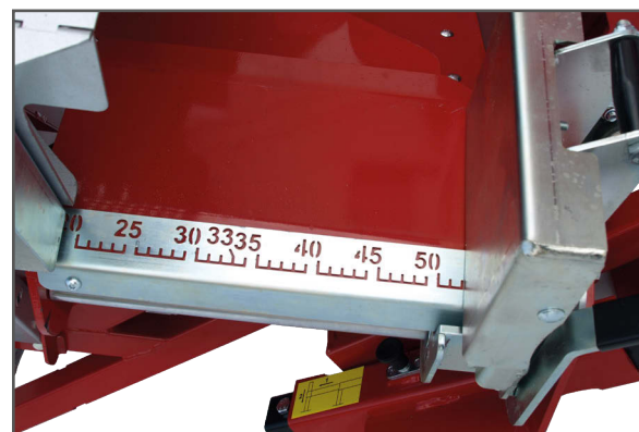
Verstellbarer Längenanschlag mit Feinstufen von 200 - 520 mm
