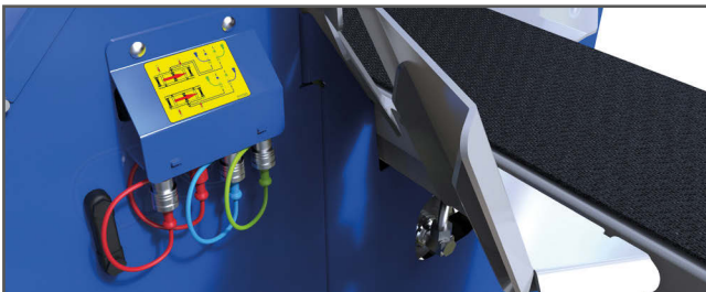
Hydraulischer Ausgang für das RCA-Zubehör wie z. B. Längs- und Querförderer RN 5000.
