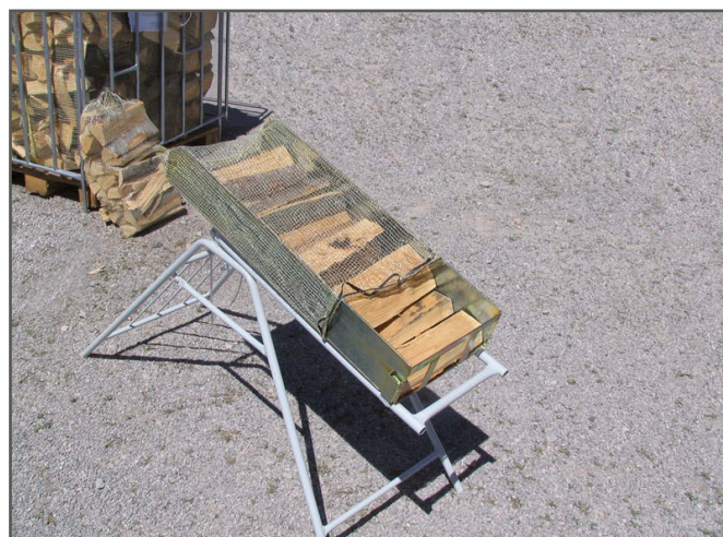
Einfüllgestell für 40 oder 60/80 I Netzsack mit Kippstativ
