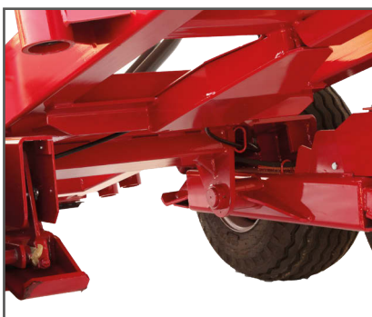
Robuste Achsbolzen (70 x 400 mm) mit Verstärkung
