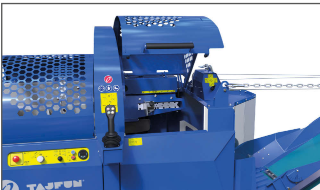
Durch das Öffnen der Schutzhaube sind alle Maschinenfunktionen außer Betrieb.
