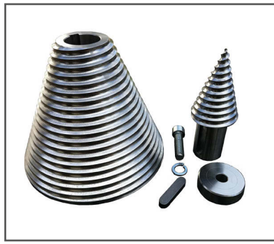
Zweiteiliger Kegel mit ø 245 mm (2-schneidiges Gewinde) für KB 630, KB 800 und KB-S 800
