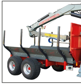
Einlegewanne halbe Höhe aus 4 mm Stahl, St 52.3
