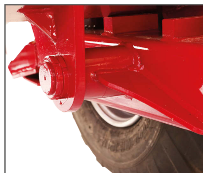
Robuste Achsbolzen (70 x 405 mm) mit Verstärkung
