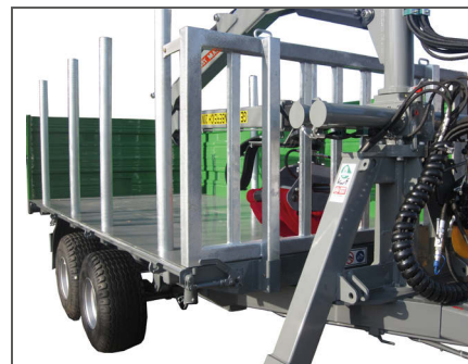
Stabile Rungen und Schutzgitter, steckbar Rungentaschen verstärkt, Zentralverriegelung seitlich
