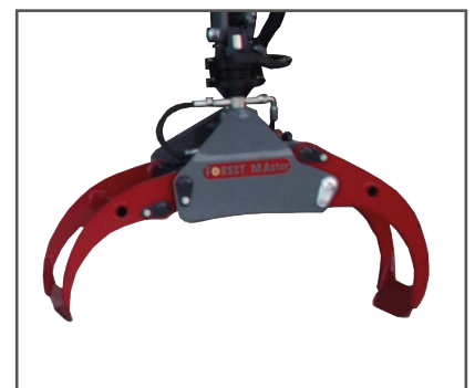
Zange HZ 10 (Schenkelbreite 300 mm)
