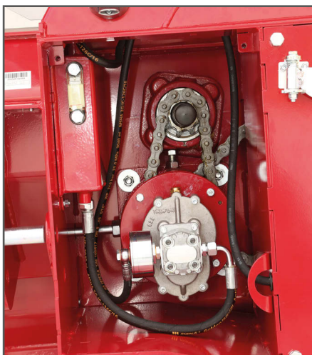
Antrieb der Hydraulikpumpe über Getriebe mit Druckfilter
