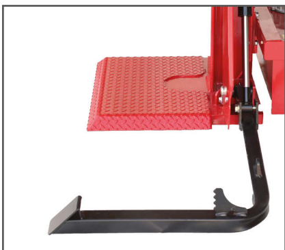
Hydraulischer Stammheber 13 - 27 t
