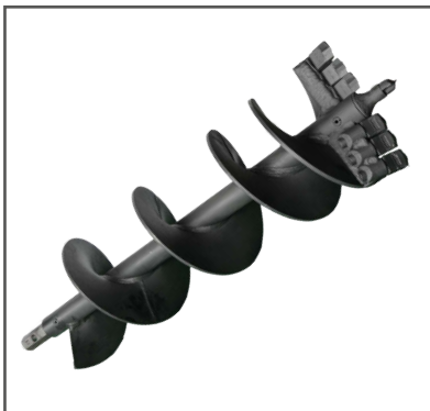
Erdbohrer mit Hartmetallzähnen (Zähne und Bohrspitze auswechselbar), Nutzlänge 1.000 mm, Bohrkopf 2-schneidig, gepanzert und verstärkt
