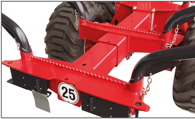
Verschiebbare Verlängerung 1,6 m inkl. Rungenträger und 2 Rungen
