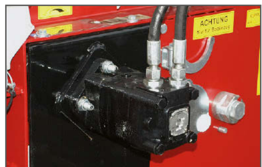
Hydraulischer Antrieb - lose (Erstmontage ca. 2 Stunden)
