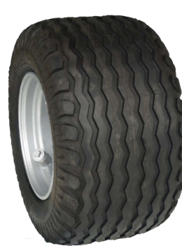
480/45-17 16 PR ET-35 Rillenprofil
