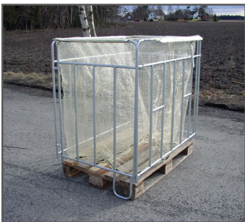
Stativ (verzinkt) mit aufklappbarem Rahmen für 1.000 l Netzsäcke
