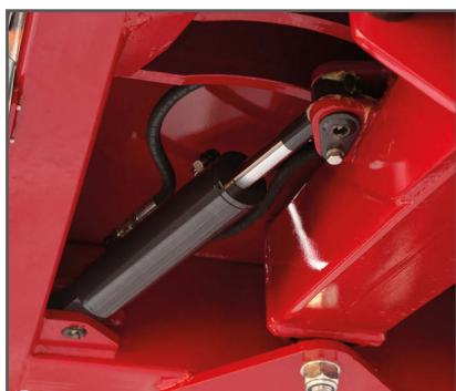
Deichsellenkung mit 2 Zylindern
